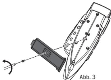
3. Öffnen Sie das Batteriefach mit einem Kreuzschlitz-Schraubendreher und legen Sie 4 x 1,5V „AA“ Batterien (nicht im Lieferumfang enthalten) in das Batteriefach ein. Auf richtige Polarität achten (siehe Kennzeichnung im Batteriefach). Anschließend den Deckel wieder auf das Batteriefach schrauben (Abb. 4).
