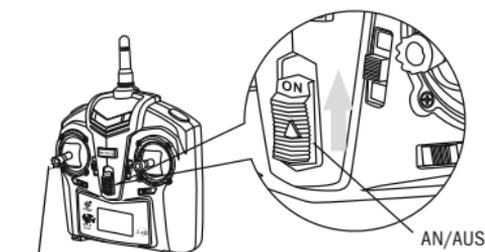
Gashebel der Fernbedienung in Nullstellung bringen (komplett nach unten schieben).
