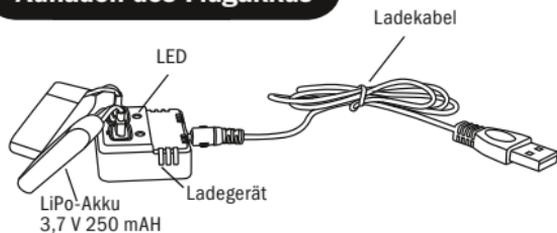
Stecken Sie den USB-Stecker in einen freien USB-Port an Ihrem Computer. Stecken Sie nun den Ladestecker in die Ladebuchse des LiPo-Ladegeräts. Anschließend die LiPo-Akkus in das Ladegerät stecken. Die rote Lade-LED leuchtet auf und zeigt den Ladevorgang an. Sobald die Lade-LED erlischt ist der Ladevorgang abgeschlossen.
